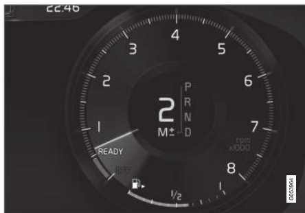
manuális fokozatváltási mód a járművezetői kijelzőn 3 .
