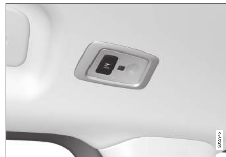
A panorámateetővel* felszerelt járművekben két lámpa egység van, a tető két oldalán.
