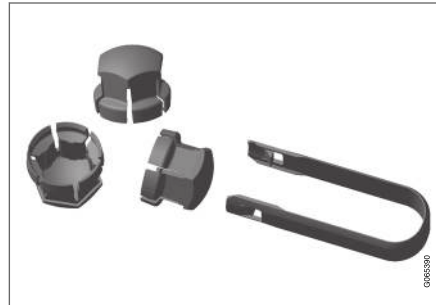
Szerszám a kerékcsavark műanyag sapkájának eltávolításához.
