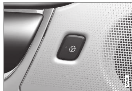
Záró gomb visszajelző lámpával a hátsó ajtóban.
