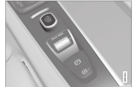
Indító gomb az alagútvezérlőn.
