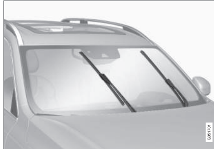
Balais d'essuie-glace en position d'entretien.
