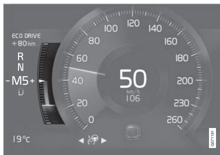
Compteur ECO sur l'écran conducteur 8 pouces.
