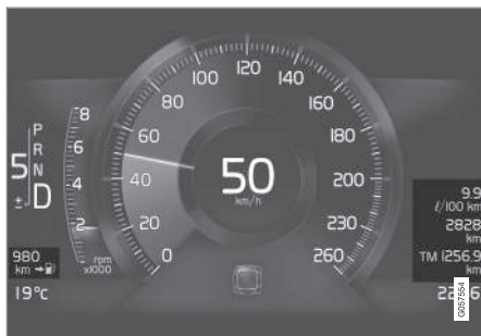
Exemple d'informations de l'ordinateur de bord sur l'écran conducteur de 8 pouces. L'illustration est schématique, les détails peuvent varier selon le modèle de la voiture.
