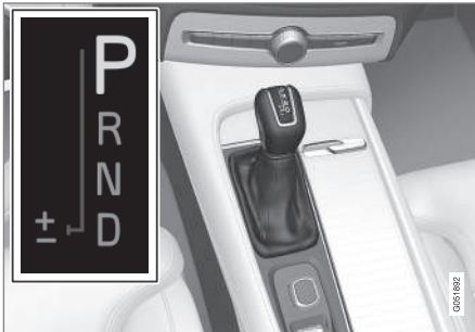
Vue d'ensemble du gros levier de vitesses avec grille de passage des rapports sur l'écran conducteur.
