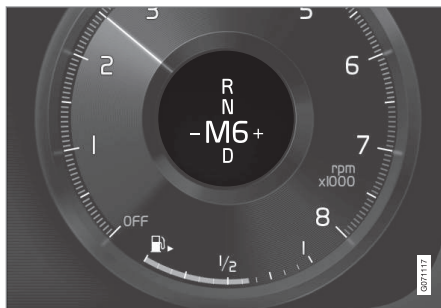
Vue d'ensemble de la grille de positions sur l'écran conducteur, pour un petit levier de vitesses.
