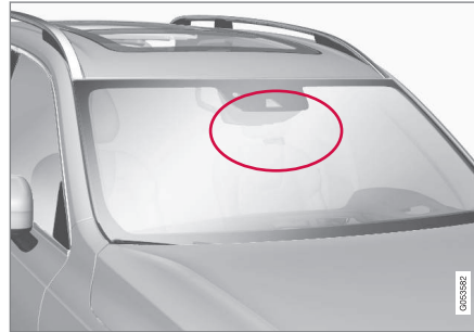
Emplacement de l'unité radar.
