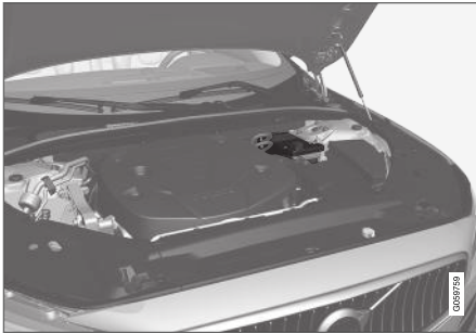
Varuaku asub amordipüstaku kõrval olevas kastis.
