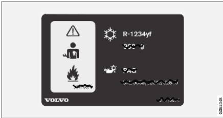
2 Külmutusainet R1234yf kasutava kliimasüsteemiga auto kleebis.
