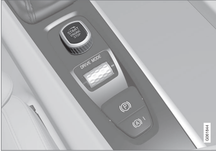
Tünel konsolundaki çalıştırma düğmesi.
