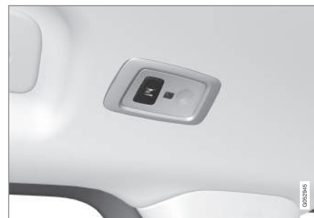
No automóvel com teto panorâmico* existem duas unidades de lâmpadas, uma em cada lado do teto. 7
