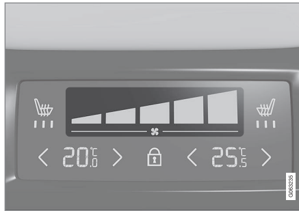
터널 콘솔 뒤쪽의 온도조절 패널의 팬 컨트롤.
