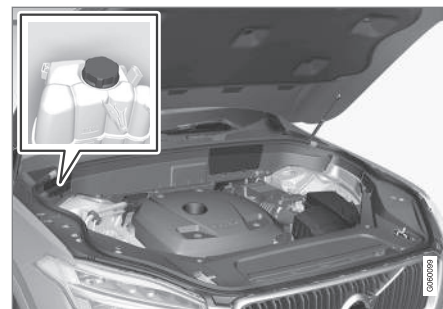
Vase d'expansion du système de refroidissement
