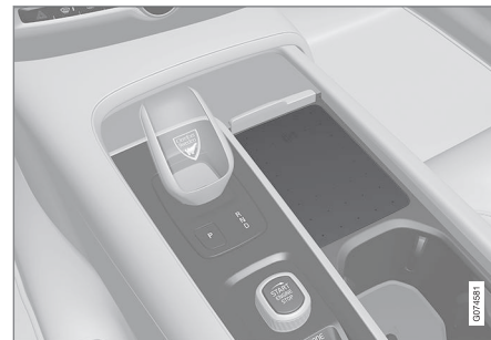
Chargeur sans fil de téléphone de la console de tunnel.
