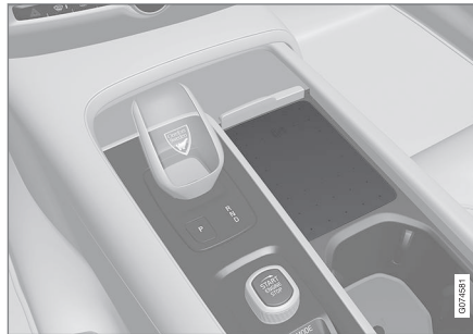
Bezdrátová nabíječka telefonu v tunelové konzole.
