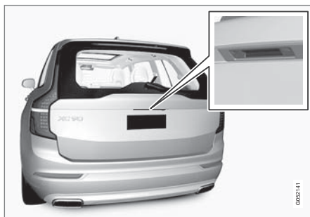
尾門上的橡膠壓板只能用於開鎖。
