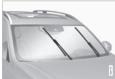
Pióra wycieraczek w pozycji serwisowej.
