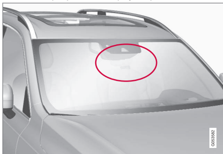
Umiejscowienie modułu radarowego
