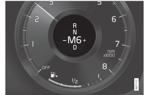
Wskaźnik zmiany biegu na 12-calowym wyświetlaczu kierowcy dla małej dźwigni zmiany biegów*.
