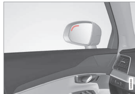
Местоположение на лампата за BLIS
