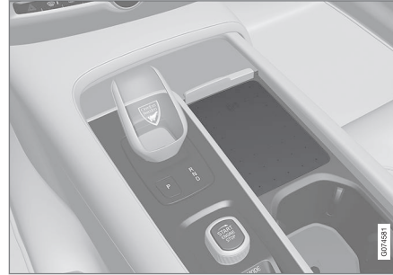
Tünel konsolundaki kablosuz telefon şarj cihazı.
