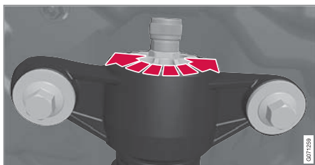
調整位置を変更するには、アジャスターのノブを時計回りと反時計回りにそれぞれ回します。
