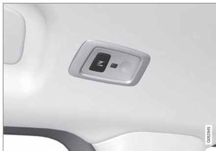
パノラマルーフ*装備車の場合、ランプユニットが2個(ルーフの各側に1個ずつ)あります。
