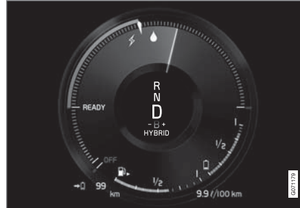
تعرض شاشة السائق القوة الدافعة للمحرك الكهربائي ومحرك الاحتراق الداخلي.
