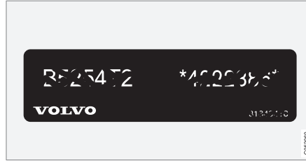
4 Motor kodu ve motor seri numarası etiketi. Bazı motor alternatifleri için etiket yoktur. Bu durumlarda, kazınmış motor kodu, doğrudan motordan okunabilir.
