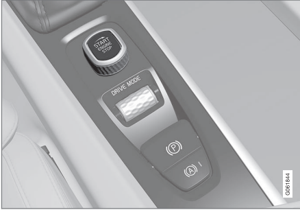
Tünel konsolundaki çalıştırma düğmesi.
