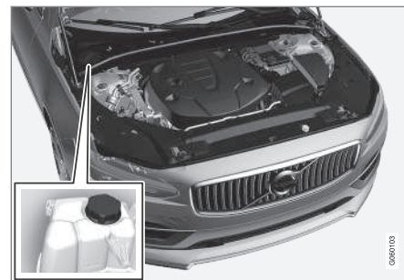
Raztezna posoda za hladilno tekočino, vozilo z vola- nom na levi
