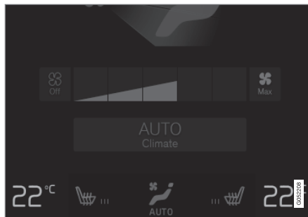
Botões de temperatura na linha da climatização.
