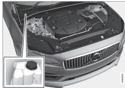
Aušinimo skysčio išsiplėtimo bakelis, automobilis su vairu dešinėje pusėje
