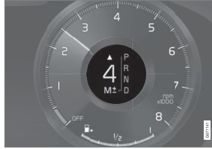
مؤشر تعشيق التروس في شاشة السائق قياس ١٢ بوصة، في حالة ذراع تغيير التروس الكبير*.
