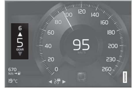
مؤشر تغيير التروس في شاشة السائق قياس ٨ بوصة.
