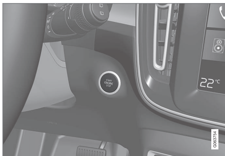
Umiestnenie štartovacieho tlačidla.
