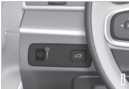
Koliesko (doľava) na úpravu jasu interiéru.
