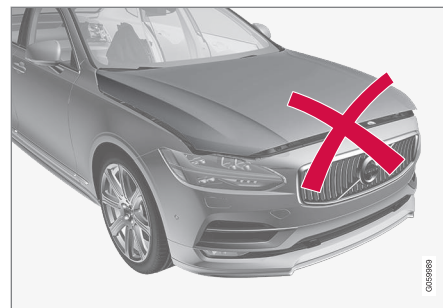
Niedomknięta pokrywa silnika.
