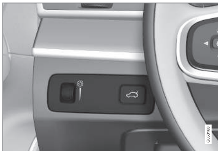
Molette (à gauche) de réglage de la luminosité intérieure.
