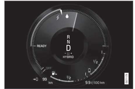
Écran conducteur en cas de marche avant avec moteur électrique et à combustion.
