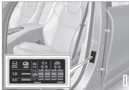
Emplacement de l'autocollant de pression des pneus
