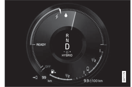
تعرض شاشة السائق القوة الدافعة للمحرك الكهربائي ومحرك الاحتراق الداخلي.
