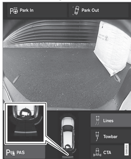
Skjermen kan vise fargede følerfelt på bilsymbolet.
