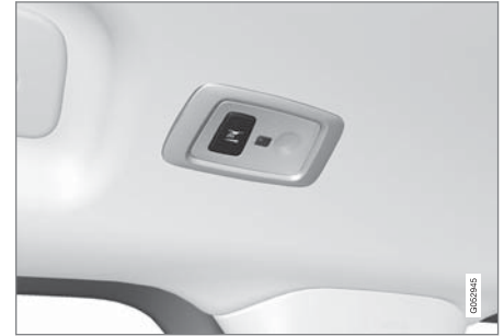
في السيارات المزودة بسقف بانوراما* توجد وحدات مصابيح واحدة في كل جهة من جهتي السقف.
