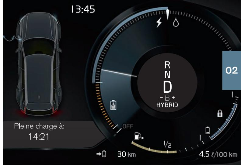
fie que la batterie hybride est chargée si son niveau de charge est bas. **Hold** signifie que le niveau de batterie est conservé pour une utilisation ultérieure.
