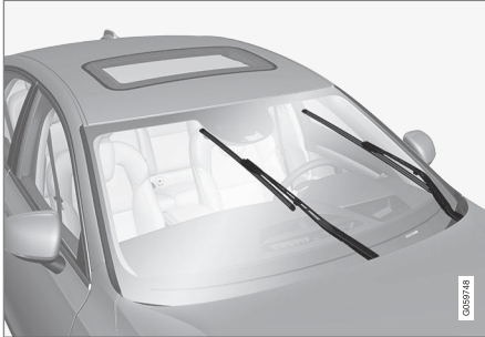
Balais d'essuie-glace en position d'entretien.
