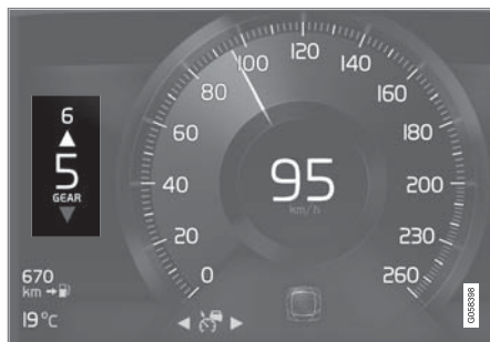
8 吋駕駛人顯示器中的換檔指示器。
