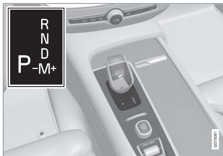
小型排檔桿和駕駛人顯示器中的換檔模式概覽。
