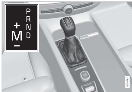
大型排檔桿和駕駛人顯示器中的換檔模式概覽。
