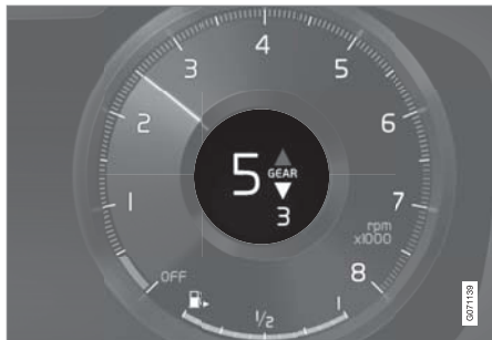
12 吋駕駛人顯示器*中的換檔指示器。
