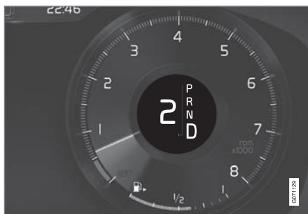
駕駛人顯示器當以大型排檔桿方向盤撥片換檔時。
