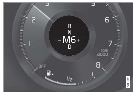
小型排檔桿的 12 吋駕駛人顯示器中的換檔指示器*。
