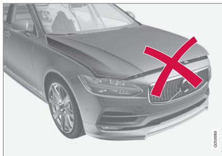
引擎蓋並未完全關閉。
