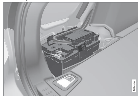
Zagonski akumulator je v prtljažnem prostoru.
