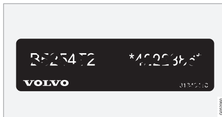
4 Nalepka za kodo in serijsko številko motorja. Za nekatere motorne različice nalepka ni na voljo. V teh primerih lahko preberete kodo motorja, ki je vgrajena neposredno na motorju.
