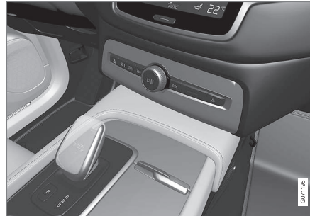
Prehľad malého voliča prevodových stupňov, kde nie je možné deaktivovať poistku radenia prevodových stupňov.
