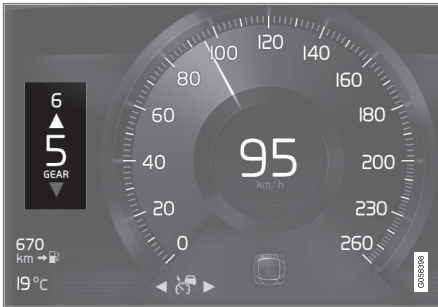
Indikátor prevodových stupňov na 8-palcovom displeji vodiča.
