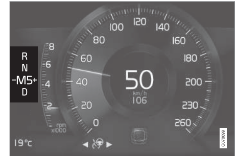
Indikátor prevodových stupňov na 8-palcovom displeji vodiča pre malú radiacu páku.
