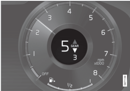
Indikátor prevodových stupňov na 12-palcovom displeji vodiča*.
