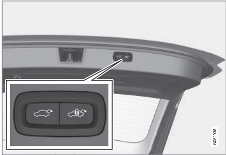
Pogas/pogu atrašanās vieta bagāžas nodalījuma durvju apakšpusē.
