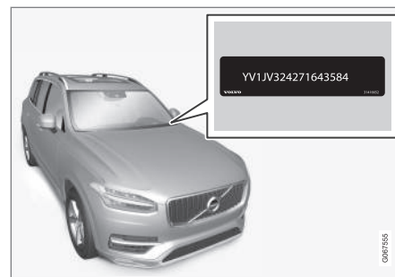
VIN visos modeļos atrodas līdzīgā vietā.
