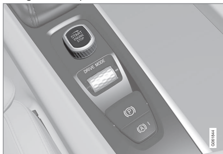
Iedarbināšanas slēdzis tuneļkonsolē.
