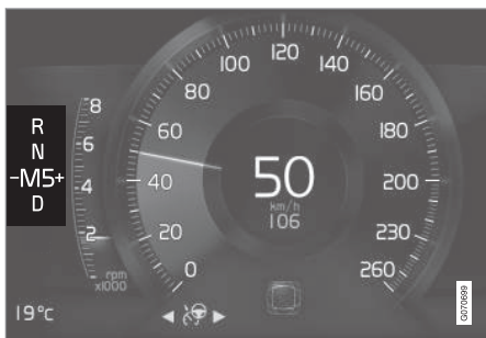
Pārnēsumu pārslēgšanas indikators 8 collu vadītāja displejā mazajai pārnēsumu pārslēgsvirai.
