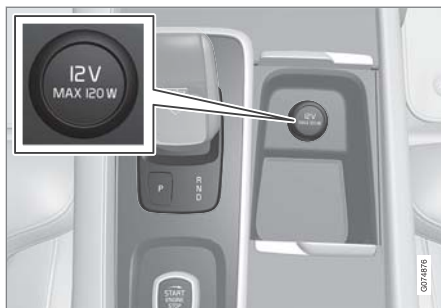
携帯電話充電器がない車両用のトンネルコンソールのフロント電源ソケット*
