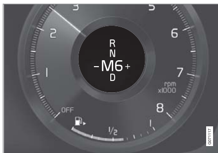
ドライバーディスプレイのシフトパターンの概観 (小型セクターレバー)
