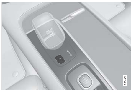
小型セレクターレバーのセレクターレバーとP位置の概観
