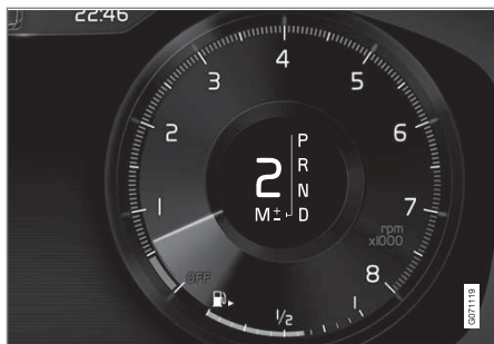
ドライバーディスプレイのシフトパターンの概観 (大型セクターレバー)
