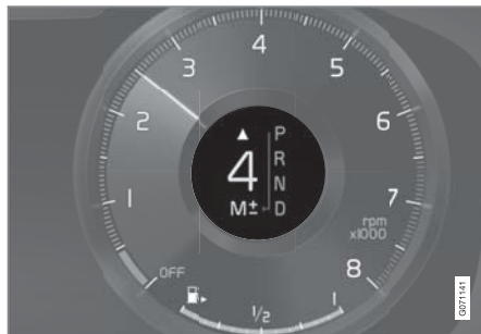
12インチドライバーディスプレイの大型セクターレバー*用ギヤシフトインジケータ
