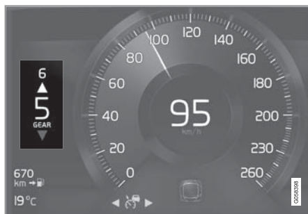
8インチドライバーディスプレイのギヤシフトインジケータ
