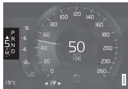
8インチドライバーディスプレイの大型セクターレバー用ギヤシフトインジケータ
