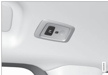
パノラマルーフ*装備車の場合、ランプユニットが2個(ルーフの各側に1個ずつ)あります。
