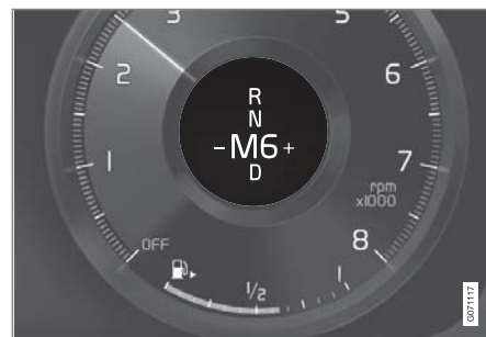
12インチドライバーディスプレイの小型セクターレバー*用ギヤシフトインジケータ
