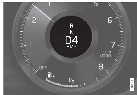
Écran conducteur lors d'un changement de rapport avec les palettes du volant, petit levier de vitesses.
