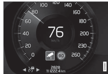
駕駛人顯示幕中與測速相機和速限相關的資訊範例
