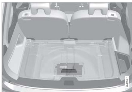
若車輛是配備 48V 支援電瓶，則位於行李廂下方。48V 支援電瓶上的盒子僅限由授權服務廠拆卸。
