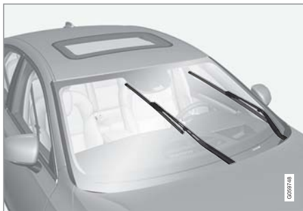
位於維修位置的雨刷片。
