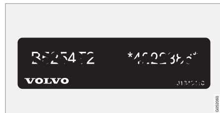
4 引擎代碼印記及引擎序號。特定引擎類型沒有印記。在這些情況下，可在引擎上直接讀取刻上的引擎代碼。
