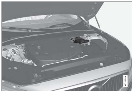
12 V 支援電瓶位於支撐桿旁的電瓶箱中。
