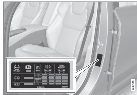
A gumibroncsnyomás címke elhelyezkedése
