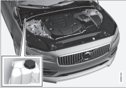
Hűtőfolyadék tágulási tartálya, balkormányos autó
