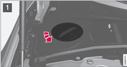
Hűtőfolyadék tágulási tartálya, balkormányos autó
