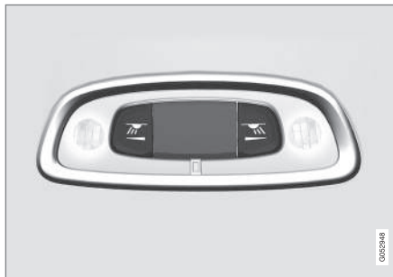
Olvasólámpák a hátsó ülés felett.
