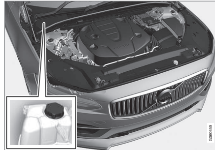
Hűtőfolyadék tágulási tartálya, jobbkormányos autó
