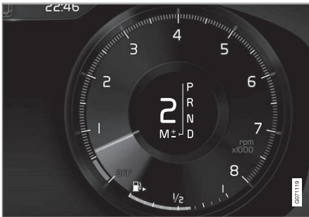
Дисплей на водача при смяна на предавки с лопатките на волана в ръчен режим на превключване на предавки, голям скоростен лост.
