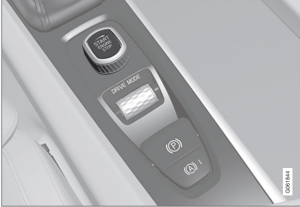
Tünel konsolundaki çalıştırma düğmesi.
