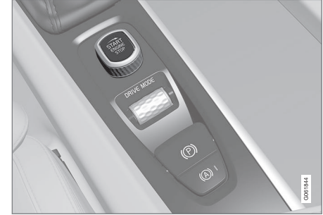
Tünel konsolundaki çalıştırma düğmesi.
