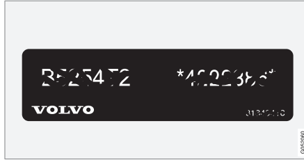
4 Motor kodu ve motor seri numarası etiketi. Bazı motor alternatifleri için etiket yoktur. Bu durumlarda, kazanmış motor kodu, doğrudan motordan okunabilir.
