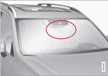
Radar ünitesi konumu
