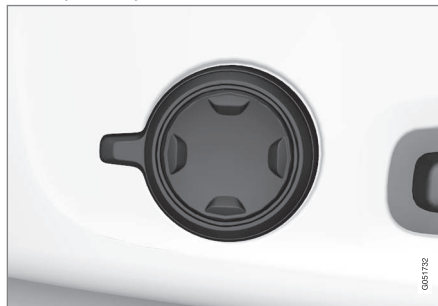
Multifunksjonsbryteren, i biler med 4-veis korsryggstøtte*.
