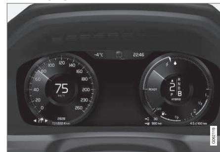
Førerdisplayet viser informasjon om bl.a. hastighet og f.eks. innkommende samtaler eller informasjon om hvilken sang som spilles.
