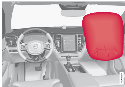
Kollisjonspute på passasjersiden i forsetet.
