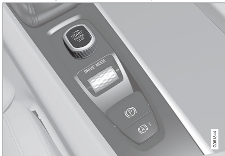
Startbryteren i tunnelkonsollen.
