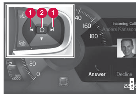
駕駛人顯示器 4 中的訊息範例與方向盤右側鍵盤。
