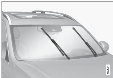
位於維修位置的雨刷片。
