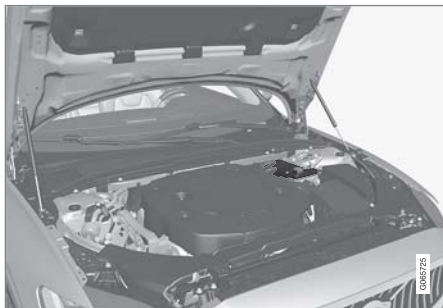
12 V 支援電瓶位於引擎室。
