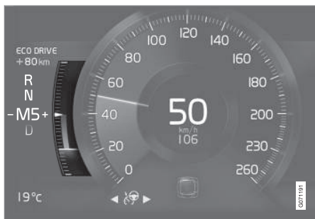
Merilnik Eco na 8-palčnem voznikovem zaslonu.
