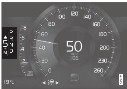
Pokazatelj izbrane prestave za 8-palčni voznikov zaslon za veliko prestavno ročico.
