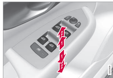
Upravljanje električno pomičnih stekel.
