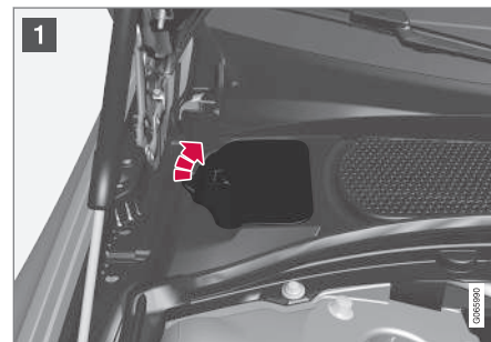
Raztezna posoda za hladilno tekočino
