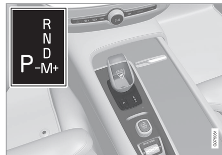
Pregled majhne prestavne ročice in vzorca prestav na voznikovem zaslonu.
