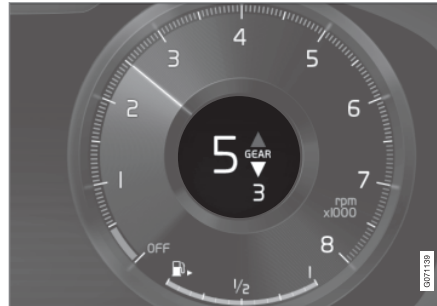
Girindikator på 12-tommers førerdisplay*.
