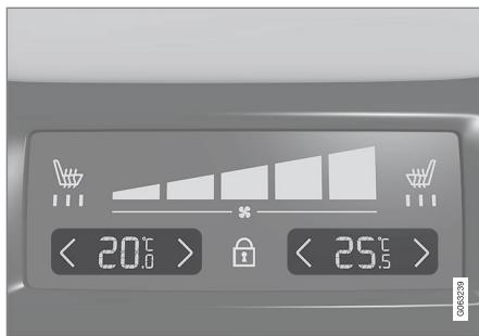
Temperaturbryter på klimapanelet bakpå tunnelkonsollen.
