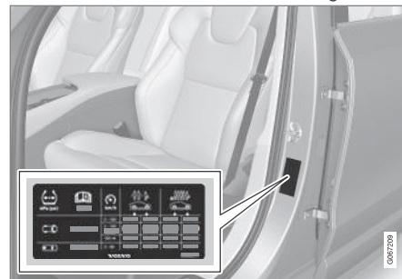
A gumiabroncsnyomás címke elhelyezkedése
