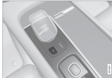
A fokozatváltó kar és a P állás áttekintése kis sebességváltó kar esetén.
