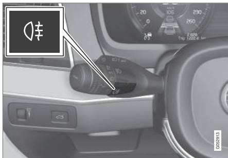
Tlačidlo pre zadné hmlové svetlá.
