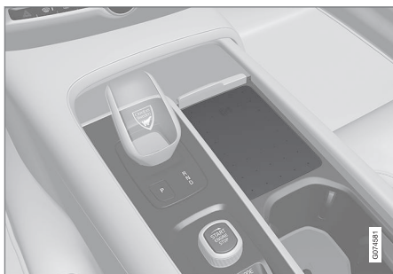
Bezdrôtové nabíjanie telefónu v konzole tunela.
