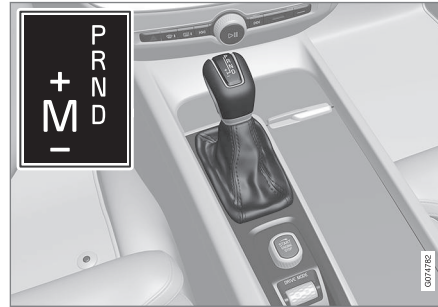
Prehľad veľkej radiacej páky a vzoru radenia na displeji vodiča.
