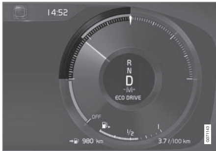
Eco ukazovateľ na 12-palcovom displeji vodiča*.
