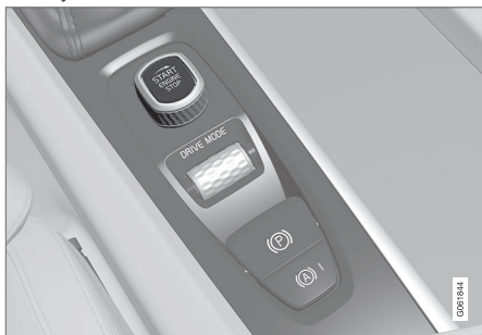
Štartovací gombík v konzole tunela.
