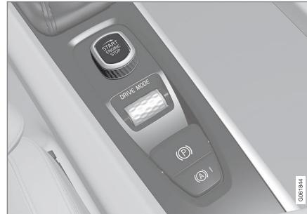
Štartovací gombík v konzole tunela.
