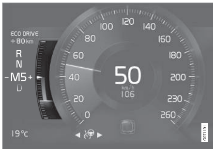
Eco ukazovateľ na 8-palcovom displeji vodiča.
