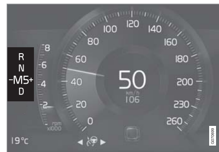
8 インチドライバーディスプレイの小型セクターレバー用ギヤシフトインジケータ
