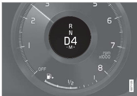
ステアリングホイールパドルでギヤをシフトしているときの、ドライバーディスプレイ（小型セレクトターレバー）
