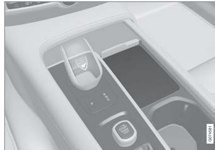
トンネルコンソールのワイヤレス携帯電話充電器
