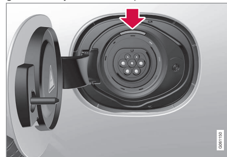
A LED lámpa elhelyezkedése az autó bemenő töltőaljzatán.
