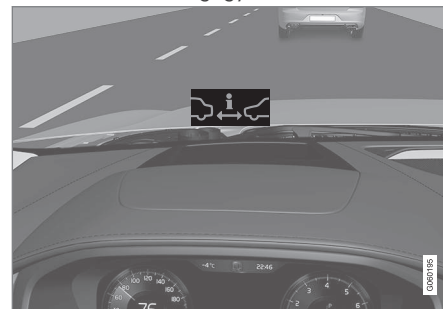
Távolságfigyelmeztetés szimbólum a szélvédőn szélvédőre vetített kijelzővel.
