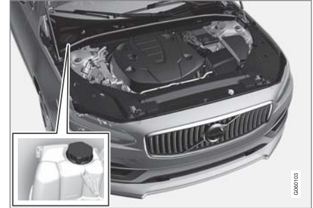
خزان التمدد لسائل التبريد، سيارة ذات عجلة قيادة يسرى
