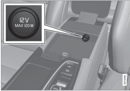
مقبس كهربائي بقوة ١٢ فولت في كونسول النفق، المقعد الأمامي.
