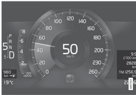
8 吋駕駛人顯示器中的旅程電腦資訊範例。此略圖僅供參考 - 實際零件會隨車款而異。
