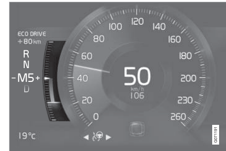
Medidor ECO no mostrador do condutor 8 polegadas.
