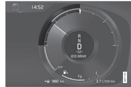
Medidor ECO no mostrador do condutor 12 polegadas*.
