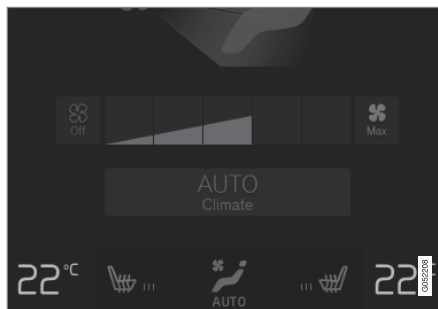
Botões de temperatura na linha da climatização.
