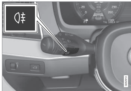
Wyłącznik tylnego światła przeciwmgielnego.
