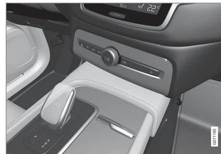
Vue d'ensemble du petit levier de vitesse pour lequel il n'est pas possible de désactiver le blocage de sélecteur de vitesses.
