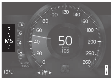
Indicateur de rapport sur l'écran conducteur 8 pouces, pour petit levier de vitesse.
