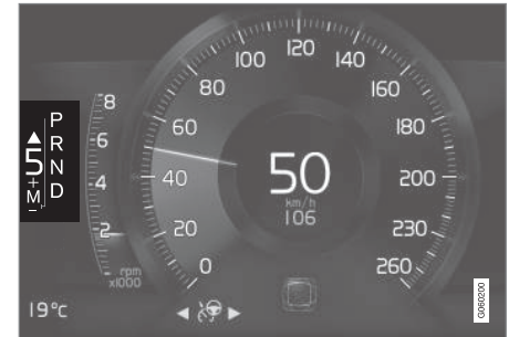
Indicateur de rapport sur l'écran conducteur 8 pouces, pour gros levier de vitesse.
