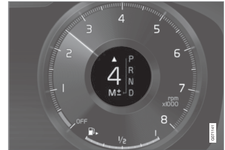
Indicateur de rapport sur l'écran conducteur 12 pouces, pour gros levier de vitesse*.
